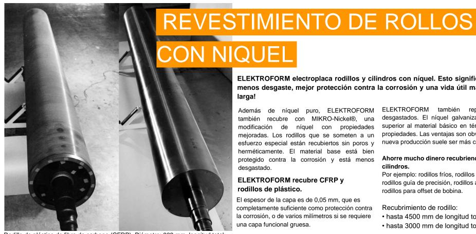
Rodillo de plástico de fibra de carbono (CFRP). Diámetro: 308 mm, longitud total: 4000 mm. Izquierda: antes del recubrimiento. Derecha: recubierto con níquel de 850 a 1000 pm. Luego se vuelve a trabajar y se lija.
