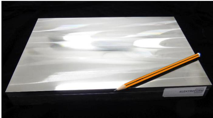
Deposición galvánica homogénea de níquel-fósforo con un espesor de capa de 8 mm, previamente fresada y lista para una estructuración con precisión nanométrica.
